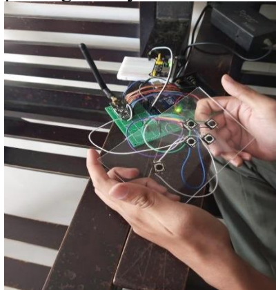
Gambar 9. Uji coba sensor gerak roda dengan menggunakan remot
